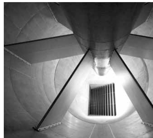
VENTILADOR DEL TÚNEL DE VIENTO EN FCA DE AUBURN HILLS
